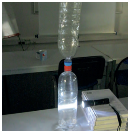
Figure 1. Montage n° 1 : deux bouteilles transparentes en plastique sont reliées entre elles par deux bouchons percés et collés entre eux (à gauche). Montage n° 2 : une bouteille en verre et son bouchon équipé d'un manomètre, d'une soupape et d'une poire provenant d'un tensiomètre médical (à droite).
