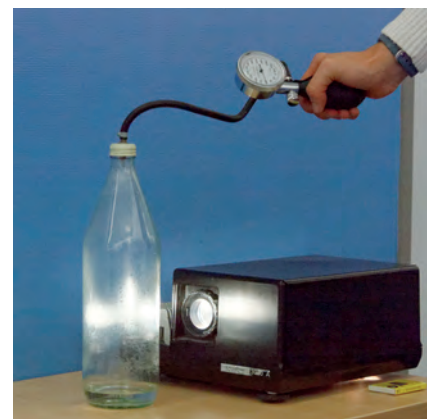
Figure 1. Montage n° 1 : deux bouteilles transparentes en plastique sont reliées entre elles par deux bouchons percés et collés entre eux (à gauche). Montage n° 2 : une bouteille en verre et son bouchon équipé d'un manomètre, d'une soupape et d'une poire provenant d'un tensiomètre médical (à droite).
