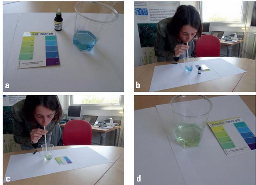
Figure 1. a) Situation initiale : l'eau du robinet a un pH neutre, voire légèrement basique, b) l'expérimentatrice commence à souffler, c) au bout d'une vingtaine de secondes, l'indicateur coloré indique que l'eau s'est acidifiée, d) situation finale : vue rapprochée du gobelet après avoir soufflé.
