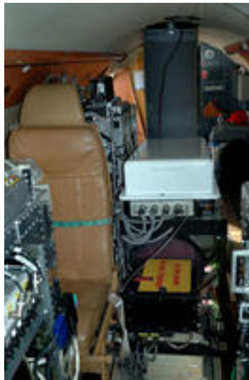
Le lidar LNG embarqué dans le Falcon 20.
