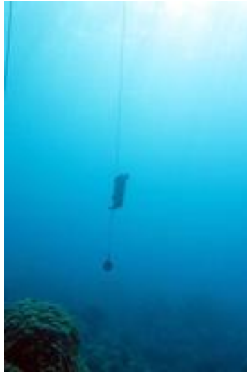
Descente d'une bouteille niskin pour prélèvements d'eau
