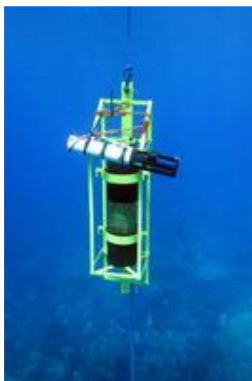
Capteurs pH et CTD RBR pour enregistrer la température, la salinité, la profondeur et la fluorescence sur le récif étudié à Europa
