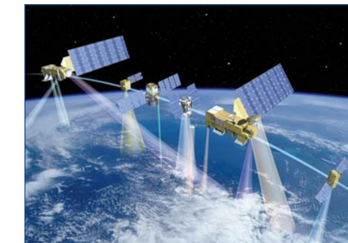
Les satellites de la constellation de l'A-Train voyagent les uns derrière les autres le long de la même orbite. En combinant les données quasi simultanées de tous ces satellites, les scientifiques peuvent étudier les paramètres importants qui influent sur le climat. L'IPSL est particulièrement impliqué dans le satellite CALIPSO sur lequel un lidar est embarqué pour l'étude des nuages.
