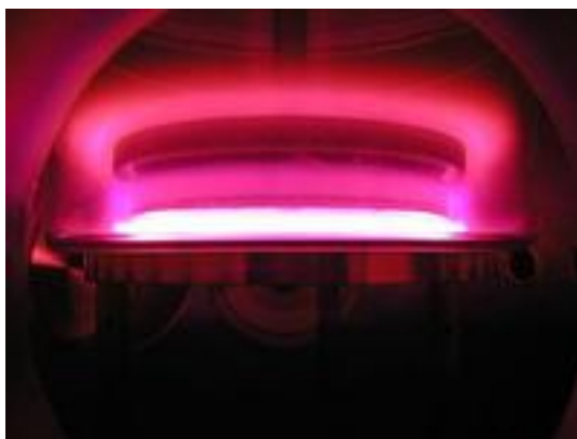
Photo d'un plasma d'azote produit dans l'expérience PAMPRE
